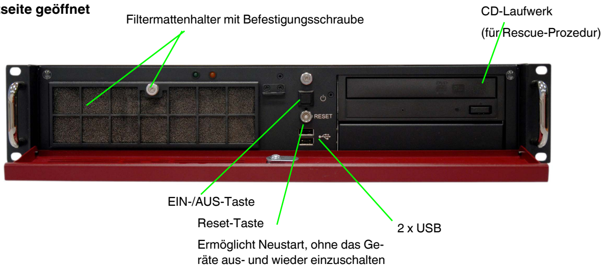
Bild 4-4 mGuard centerport Frontseite bei geöffneter Frontklappe
