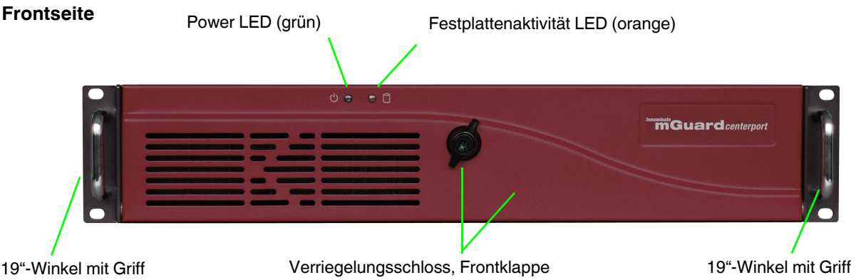
Bild 3-2 Bedienelemente und Anzeigen vom mGuard centerport - Frontseite
